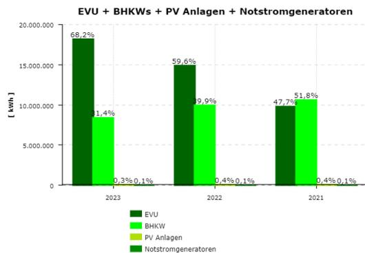
Mit steigendem Veranstaltungsbetrieb im Jahr 2023 ist auch der absolute Stromverbrauch angestiegen und der Anteil an zugekaufter Strommenge angestiegen. Die PV Anlage und die Notstromgeneratoren liegen deutlich unter 1%. Der PV Anteil wird sich voraussichtlich ab 2024 deutlich erhöhen. Baubeginn der insgesamt 8,5 MWp PV-Anlage hat im Herbst begonnen, die vollständige Inbetriebnahme ist bis 2025 geplant.
