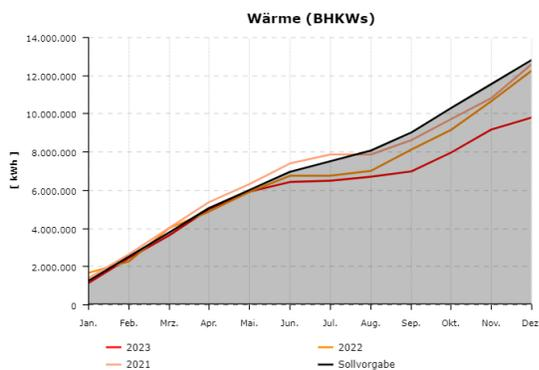
Die Blockheizkraftwerke liefen in der 2. Jahreshälfte auf Grund von technischen Störungen und wegen verringerter Wärme-, bzw. Stromabnahme teilweise nur eingeschränkt.
