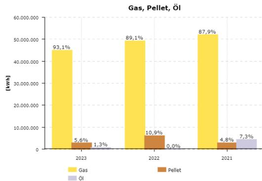
Hauptenergieträger ist immer noch das Gas. Der Holzpelletkessel war störungsbedingt kaum im Einsatz, die Ölversorgung wurde nur als Redundanz für mögliche Gasengpässe vorgehalten.
